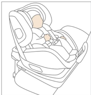
Dopo aver allacciato le cinture del bambino ruotare nuovamente la struttura del seggiolino nella posizione di partenza,
