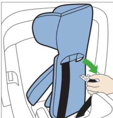
Rimuovere il poggiatesta ed estrarre le cinture per le spalle come illustrato attraverso l'imbottitura per le spalle.
