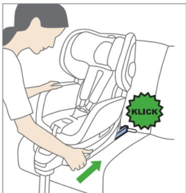
Setzen Sie nun den RECARO Zero.1 Elite an den ISOFIX-Bügel an und lassen Sie die Konnektoren hörbar einrasten.
