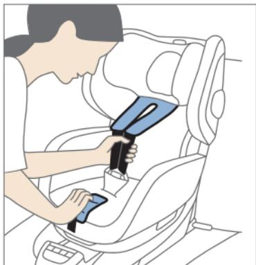
Per allentare le cinture azionare il tasto di regolazione (19) e tirare le cinture per le spalle in avanti, come indicato nella figura.
