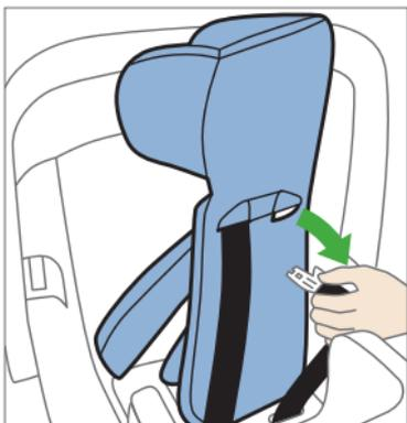
Vegye le a fejpárnát és az ábrán látható módon húzza át a vállöveget a vállpárnákon.
