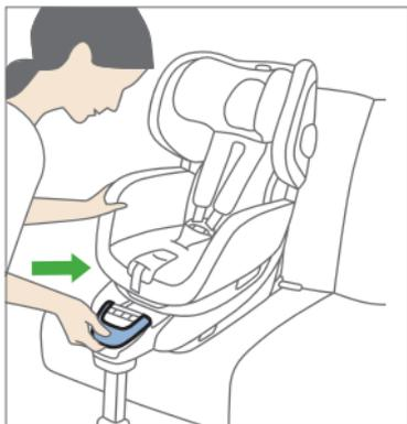
Ziehen Sie den Hebel ISOFIX-Längenverstellung (14) nach oben und schieben Sie den RECARO Zero.1 Elite Richtung Rückenlehne bis dieser anliegt.
