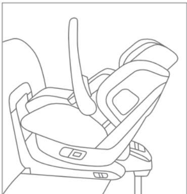
Ahora, coloque el portabebés con el asa de transporte levantado en el asiento de forma que los elementos de fijación (29) se introduzcan en el anclaje de inserción (27). A continuación, presione el portabebés con más o menos fuerza a la silla de auto. Se tiene que encajar de manera audible. Asegúrese de que el portabebés se encuentra correctamente enclavado al asiento tirando del asa de transporte.
