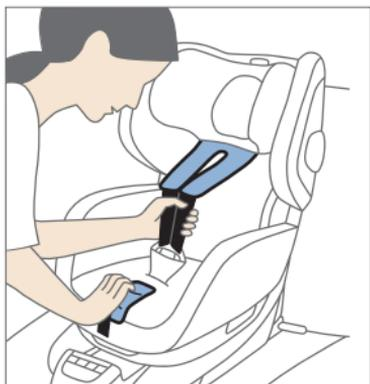
Zum Lockern der Gurte betätigen Sie die Gurtverstelltaste (19) und ziehen die Schultergurte wie gezeigt nach vorn.
