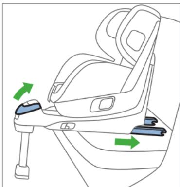
Zum Ausfahren der ISOFIX-Konnektoren betätigen Sie den Hebel ISOFIX-Längenverstellung (14) vorne, oberhalb des Stützfußes, und ziehen Sie die ISOFIX-Konnektoren (5) bis zum Anschlag aus.
