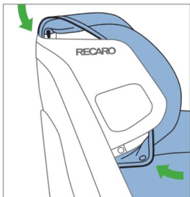
Den Bezug im Schulterbereich können Sie abnehmen, nachdem Sie die Druckknöpfe an der Außenseite geöffnet und den Bezug aus den Haken ausgefädelt haben.
