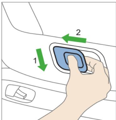
Zum Entriegeln der Drehfunktion drücken Sie zuerst die Taste in der Mitte des Entriegelungshebel Drehfunktion (13) nach unten und ziehen danach den Entriegelungshebel (13) nach außen. Sie können die Sitzschale nun zur Seite drehen.
