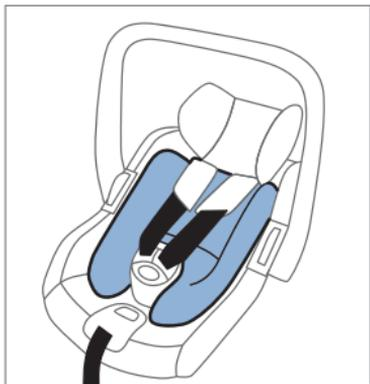
Som et ekstra element til tilpasningen, er babyskålen udstyret med en sædeformindsker (25). Den bør fjernes, før nakkestøtten indstilles i højden første gang.
