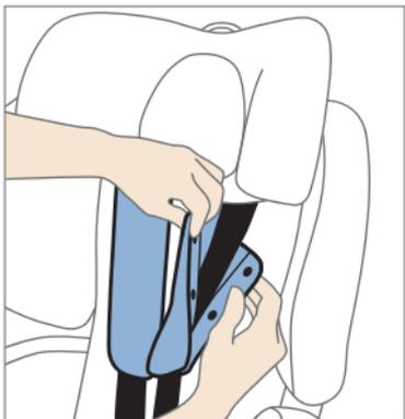
Als nächsten Schritt öffnen Sie die Druckknöpfe an den Polstern und entnehmen dann die Schultergurte.
