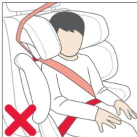
**ПОПЕРЕДЖЕННЯ!** Використання цього крісла на сидіннях в транспортному засобі, спрямованих вперек до напрямку руху, заборонене. На сидіннях в транспортному засобі, спрямованих спинкою вперед, наприклад, в мінівені або в мікроавтобусі, його використання допускається, якщо сидіння в транспортному засобі є придатним для перевезення дорослих. Знімати підголовник при монтажі крісла спинкою вперед забороняється!
