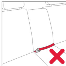
**ПРЕДУПРЕЖДЕНИЕ!** Автокресло не подходит для использования с двухточечным или поясным ремнем безопасности. Если автокресло фиксируется двухточечным ремнем безопасности, ребенок может получить серьезные или даже смертельные травмы в результате аварии.
