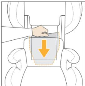
**ВКАЗІВКА!** Під час встановлення чохла в зоні під стегнами переконайтесь, що піноматеріал правильно прилягає до основи.
