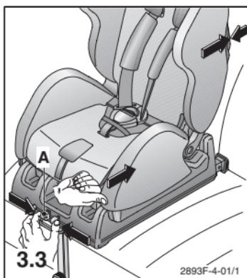
3.3 Drücken Sie die beiden grünen Knöpfe (A) um die Sperre für die erste Raste zu lösen. Danach können Sie das System ohne drücken der grünen Knöpfe nach hinten an das Fahrzeugpolster schieben.
