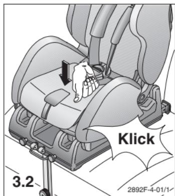
3.2 Haga engatillar el portabebés en el anclaje delantero. Levantándolo, verifique si el portabebés se encuentra engatillado por delante y por detrás.
