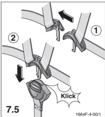
7.5 Cierre el dispositivo de cierre poniendo las dos lenguas una por encima de la otra (1) y haciéndolas engatillar en el dispositivo de cierre con un clic audible (2).
