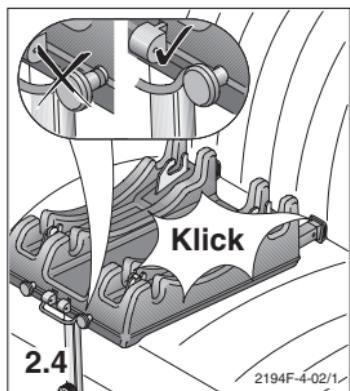
2.4 Haga engatillar los conectores Isofix en las asas Isofix. ¡La marcación roja en los botones de desbloqueo tiene que quedar desaparecida! Verifique el engatillamiento tirando de ambos lados en la plataforma.
