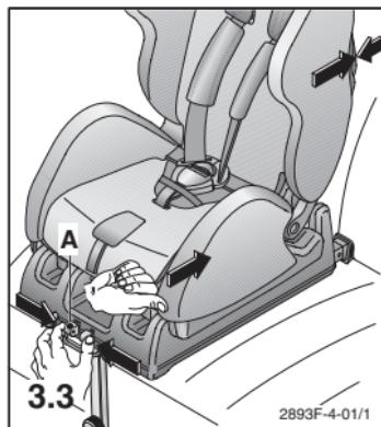
3.3 Tryk på de to grønne knapper (A) for at løsne spærren for den første position. Herefter kan du skubbe systemet baglæns op mod bilens ryglæn uden at trykke på de grønne knapper.
