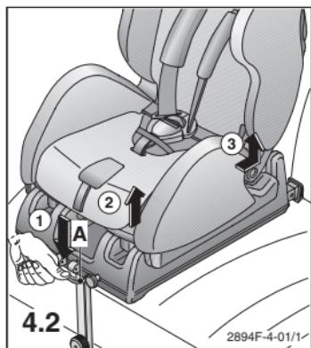
4.2 Poussez le levier de déverrouillage (A) des enclenchements avant et soulevez le siège. Poussez le siège un peu vers l'arrière et le sortir vers le haut.
