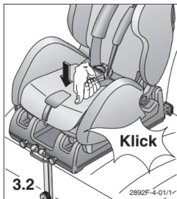
3.2 Sæt stolen ind i den forreste forankring, så der lyder et klik. Løft stolen op for at kontrollere, at den er faldet i hak både bagved og foran.
