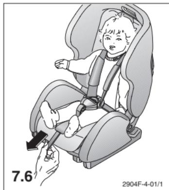
7.6 Straffen Sie die Gurte durch Ziehen des Zentralgurtes in Pfeilrichtung. Die Gurte sollten straff anliegen.
