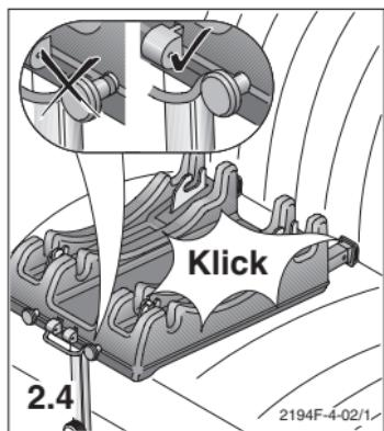
2.4 Enclenchez les raccords Isofix dans les étriers Isofix. La marque rouge aux boutons de déverrouillage ne doit plus être visible ! Contrôlez l'enclenchement en tirant à la plate-forme des deux côtés .
